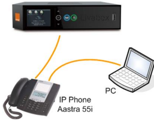
Figure 7 : branchement d'un PC sur un téléphone IP
